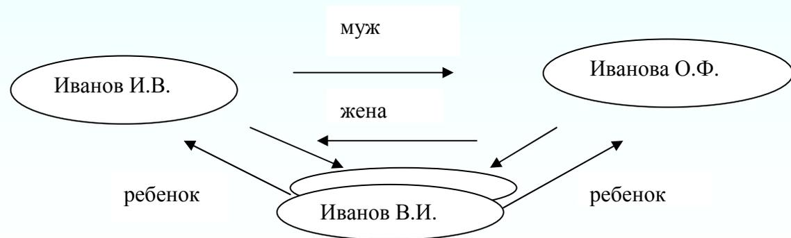
Рис.3. Фрагмент сетевой модели данных
